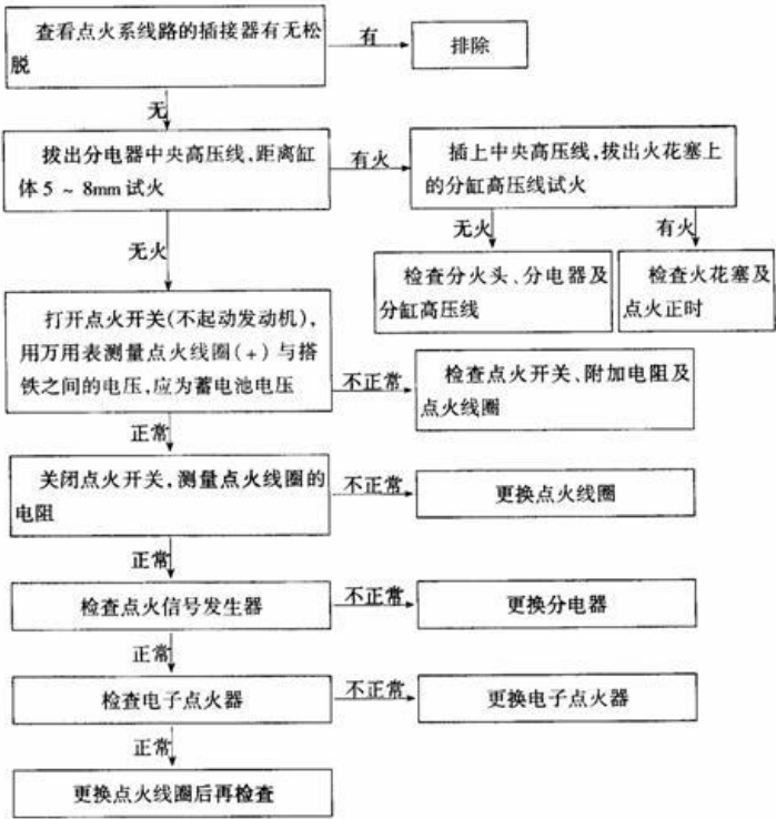
图 2-1 电子点火系故障分析图
